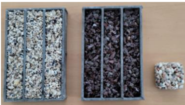
바이오콘 Bio-Concrete 왼쪽부터 패각, 골재, 자갈 From the left, shell, aggregate, gravel
